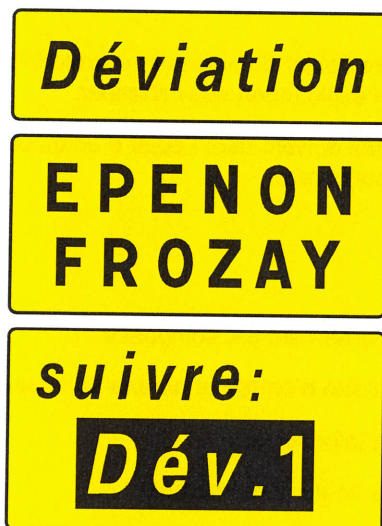
Exemple de panneau KD 79 avec le symbole "Dév." (signalisation au niveau du site d'entrée de la déviation)
